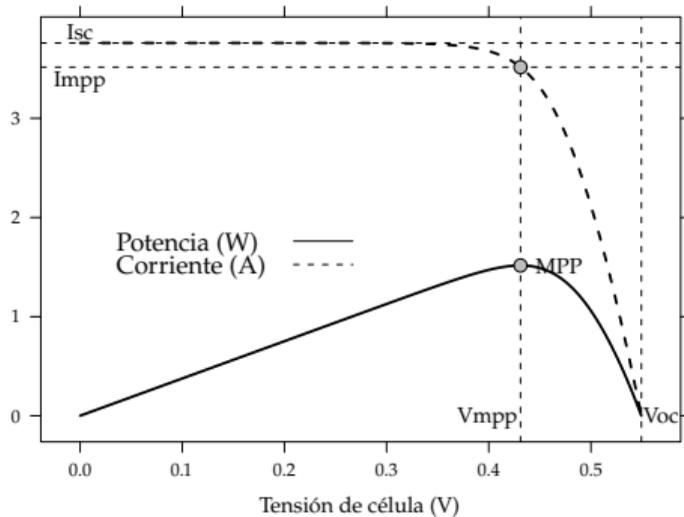
$$\begin{cases} \frac{dP}{dV} > 0 & 0 < V < V_{mpp} \\ \frac{dP}{dV} = 0 & V = V_{mpp} \\ \frac{dP}{dV} < 0 & V_{mpp} < V < V_{oc} \end{cases}$$
