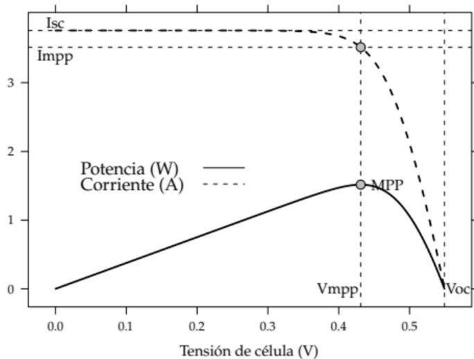
$$\begin{cases} \frac{dI}{dV} > -\frac{I}{V} & 0 < V < V_{mpp} \\ \frac{dI}{dV} = -\frac{I}{V} & V = V_{mpp} \\ \frac{dI}{dV} < -\frac{I}{V} & V_{mpp} < V < V_{oc} \end{cases}$$
